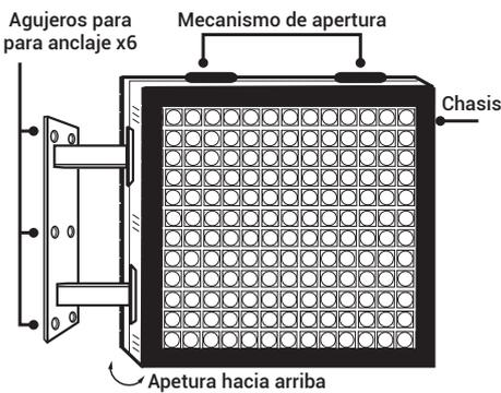
Instalación de la garra en el lado izquierdo y de pie. Respetar siempre los orificios de ventilación y su orientación
